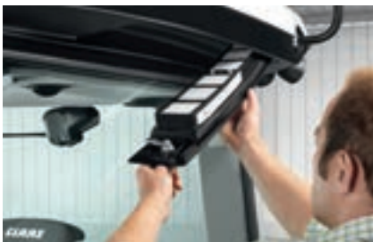
Installé à l'extérieur de la cabine, le filtre à air est facile à démonter pour la maintenance.
