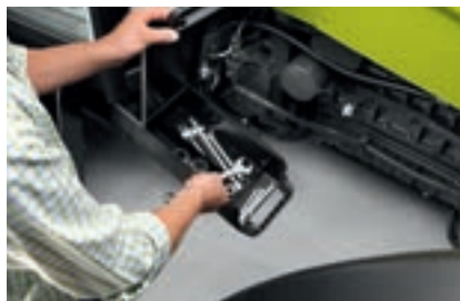
Une caisse à outils est intégrée de série au marchepied droit d'accès à la cabine.
