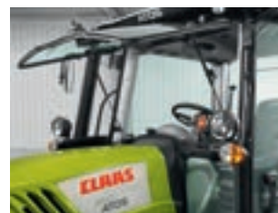
Le pare-brise s'ouvre en grand pour une ventilation naturelle de la cabine.
