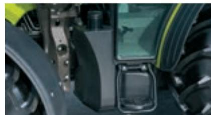
Le ravitaillement en carburant est facilité par la tubulure de remplissage située au niveau du marchepied gauche.
