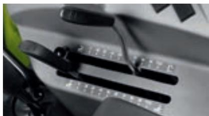
Vous avez le choix entre une commande électro-hydraulique et mécanique du relevage arrière. Les deux sont placées de façon ergonomique à droite du siège conducteur.
