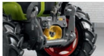
Le relevage avant en option d'une capacité de 2,8 t et la prise de force avant permettent d'étendre le champ d'application de l'ELIOS.
