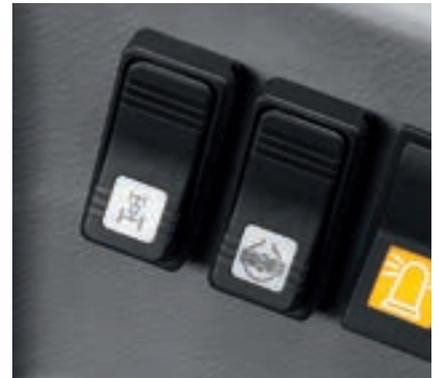
Engagement ou désengagement électro-hydraulique des 4 roues motrices et du blocage de différentiels : le désengagement de sécurité en fonction de la vitesse permet d'éviter des erreurs de commande.
