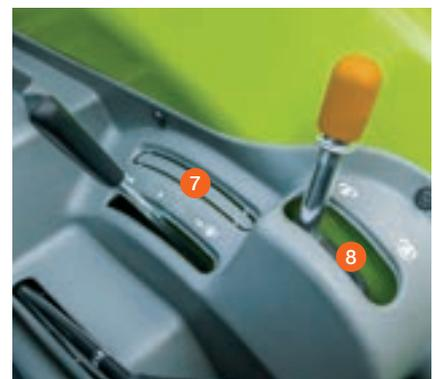
La prise de force est engagée hydrauliquement de série. Sur les tracteurs avec REVERSHIFT, l'automatisme d'engagement et de désengagement de la prise de force est disponible en option.
