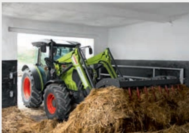
Grâce à sa hauteur hors tout minimale de 2,43 m avec cabine (seulement 1,92 m avec plate-forme et arceau rabattu) et son faible rayon de braquage de 3,47 m, l'ELIOS est idéal pour les bâtiments étroits ou les serres.
