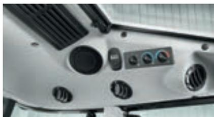
Le système de chauffage et de ventilation intègre un ventilateur à quatre vitesses et de nombreuses buses de ventilation réglables. Une climatisation réglable est également disponible.
