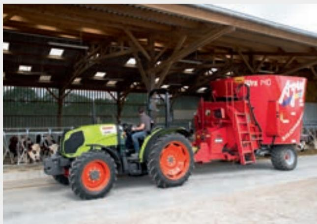
L'ELIOS propose en option un débit hydraulique cumulé de 85 l/min pour alimenter le relevage arrière et les quatre distributeurs électro-hydrauliques supplémentaires, dont la commande s'effectue par le biais de l'ELECTROPILOT et de deux commandes en ligne sur la console droite.
