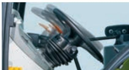
La colonne de direction réglable en hauteur et en inclinaison s'adapte à la position du conducteur.
