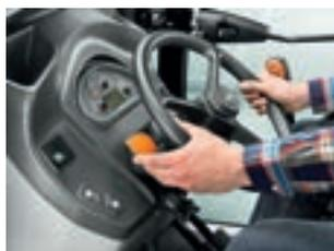
L'inverseur est situé à portée de main à gauche du volant et est commandé au choix de façon mécanique ou électro-hydraulique avec la transmission REVERSHIFT.
