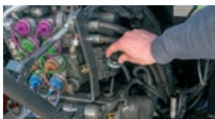
Le niveau de l'huile de transmission et de l'huile hydraulique peut être contrôlé à l'arrière avec une jauge de niveau.
