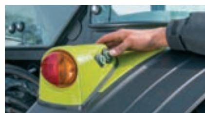
Le relevage arrière électro-hydraulique ou mécanique peut être commandé depuis l'arrière du tracteur pour l'attelage des outils.
