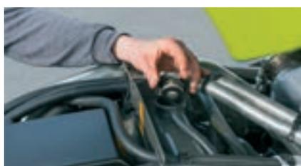
Le niveau du liquide de refroidissement peut être contrôlé au niveau du réservoir de compensation du radiateur.
