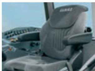
Le nouveau siège confort à suspension pneumatique est doté d'un rembourrage épais et d'un dossier réglable en hauteur.
