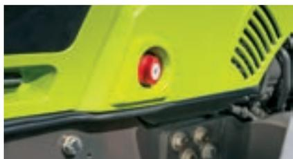
Le coupe-batterie est intégré dans le capot moteur pour une accessibilité optimale.
