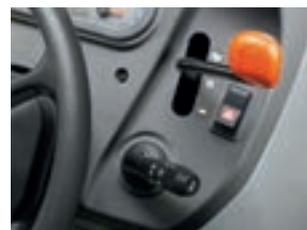
La version à 24 vitesses avant et 24 arrière est proposée au choix avec un doubleur mécanique à droite du volant ou avec le doubleur sous charge TWINSHIFT qui se commande avec le levier de commande.
