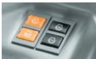
Avec l'injection électronique par rampe commune, l'ELIOS dispose de série d'une mémoire de régime moteur et d'une deuxième mémoire de régime moteur en option.
