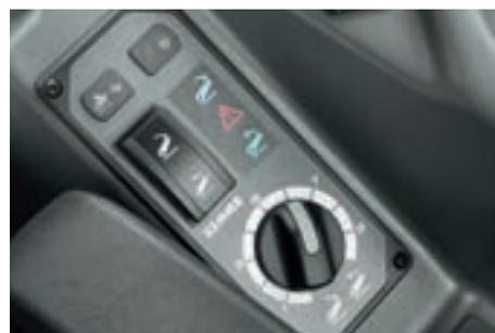
Panneau de commande du relevage arrière électro-hydraulique : montée, descente et terrage rapides. La profondeur de travail se règle avec le commutateur rotatif.
