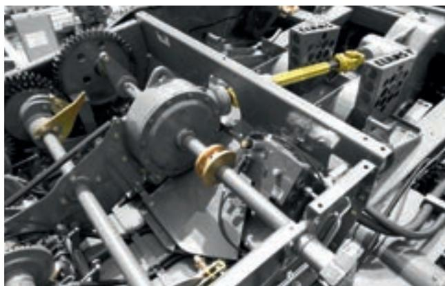
Le système TURBO FAN produit un flux d'air permanent qui circule à une vitesse de 140 km/h et protège les noueurs des impuretés.
