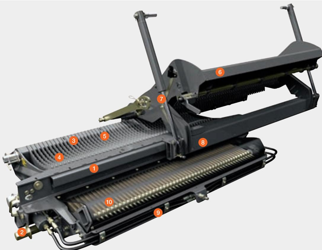
Système de tiroir CLAAS pour un changement, un nettoyage et un entretien des couteaux facilités, et des couteaux parfaitement protégés
