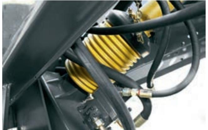
La presse QUADRANT est alimentée en huile hydraulique par la pompe située sur le boîtier d'entrée, le système de nettoyage des noueurs TURBO FAN étant approvisionné par une deuxième pompe à huile. Les fonctions telles que l'ouverture du fond rotor (RC), l'activation de la rampe à rouleaux ou de la béquille sont gérées par le système hydraulique du tracteur.
