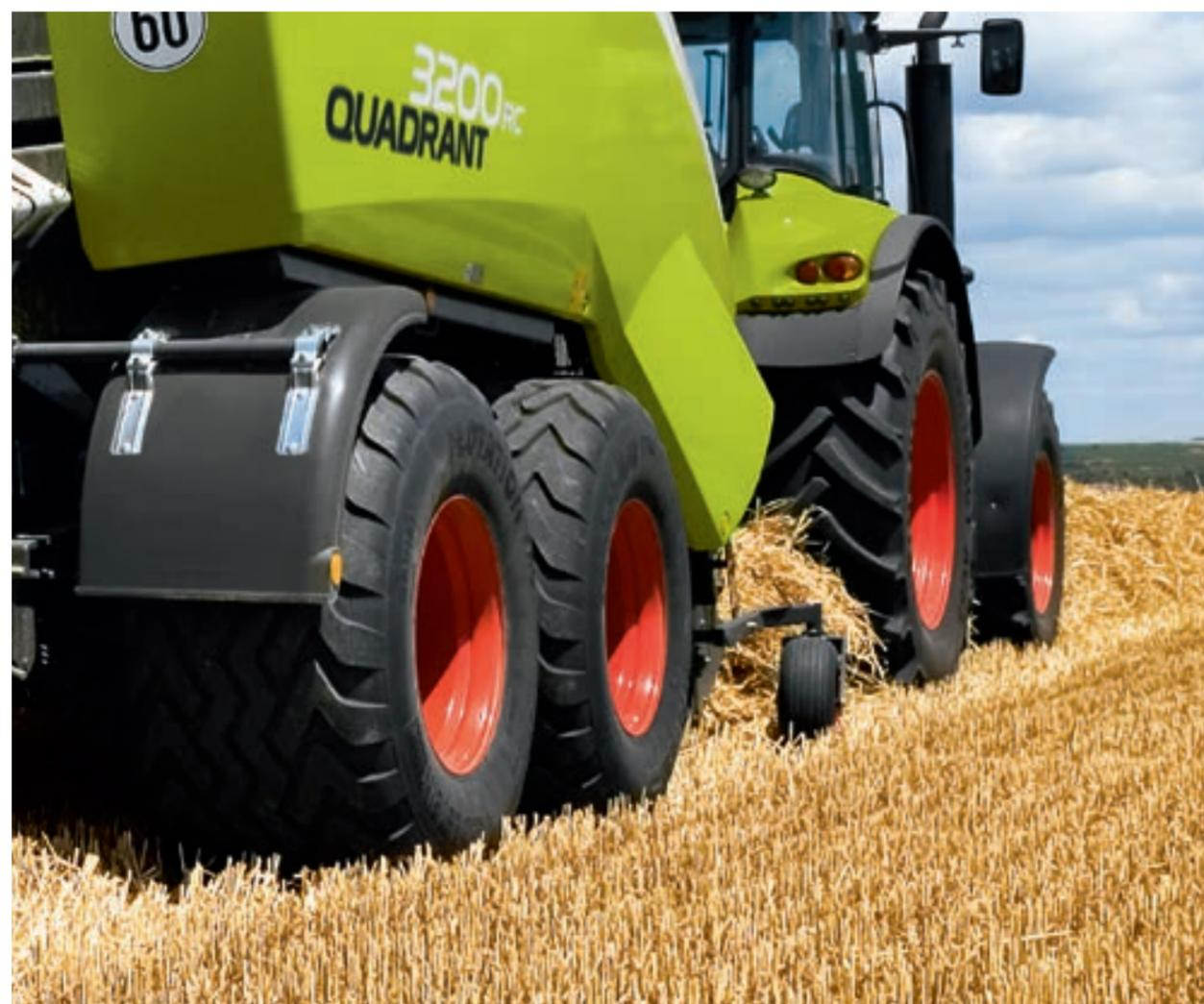
Afin de minimiser la compaction du sol, de protéger au mieux la couche végétale et d'augmenter le confort de conduite, plusieurs configurations d'essieu et différents modèles de pneumatiques sont proposés pour la gamme de presses QUADRANT. Outre une surface de contact maximale, les pneus exercent une pression minimale au sol qui permet de protéger même les sols meubles ou humides.
