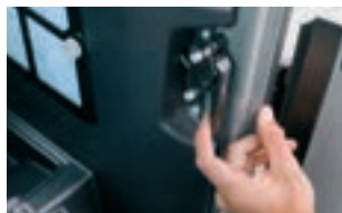
Déverrouillage de la partie supérieure de la porte via un levier en cabine
