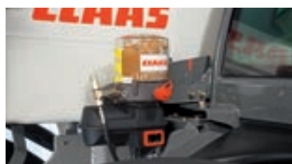
Système de graissage centralisé pour le graissage automatique de tous les points de graissage
