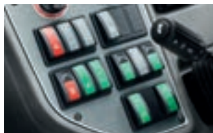
Poste de travail clairement structuré Vert : hydraulique Bleu : transmission Gris : fonctions électriques Rouge : sécurité
