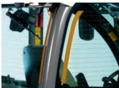
Chauffage des vitres latérales et arrière
