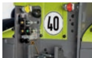
Raccords hydrauliques a l'arriere avec reservoir d'huile de fuite et freinage pneumatique de remorque
