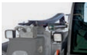
Raccord hydraulique a simple effet supplementaire installe en haut du bras telescopique
