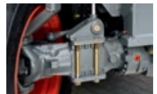
Blocage de l'essieu pendulaire arrière
