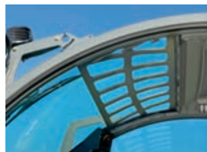
La grille de protection à l'intérieur du pare-brise évite les dépôts sur le pare-brise
