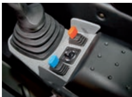
Commandes de réglage électrique des rétroviseurs et de chauffage du rétroviseur extérieur droit juste derrière le monolevier
